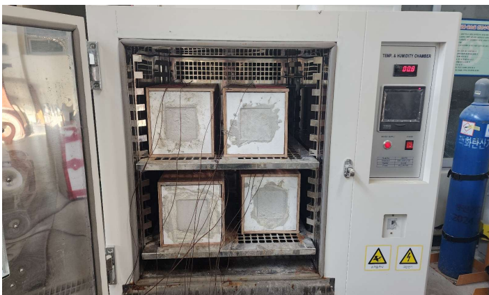
그림1. PCM 혼입 시멘트 모르타르 공시체와 동결 챔버
